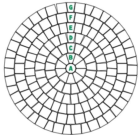
Eine Liefereinheit (Mindestabnahme) entspricht 1,03 m<sup>2</sup>. Zur Erstellung eines Vollkreises (ø 183 cm; 3,09 m<sup>2</sup>) mit sieben Kreisringen werden drei Liefereinheiten benötigt. Weitere Kreisringe lassen sich problemlos mit Urbanit 14 x 14 cm erstellen.
