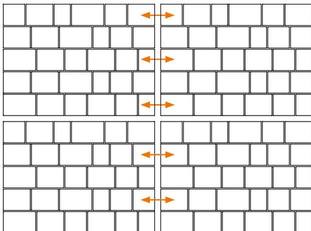
Taverna wird als Verlegeeinheit mit allen Steinformaten geliefert. Eine Einheit (Stärke 6 cm) entspricht ca. 1,1 m<sup>2</sup>. Für die Verlegung im Läuferverband müssen die markierten Steine vertauscht werden. Taverna antik wird als gerumpelte Schüttware in festem Mischverhältnis geliefert und ist nicht für die maschinelle Verlegung geeignet.
